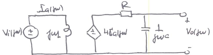
$V_o(j\omega) = \frac{1}{j\omega C} \cdot \frac{4C V_i(j\omega)}{1+j\omega RC} \Rightarrow H(j\omega) = \frac{V_o(j\omega)}{V_i(j\omega)} = \frac{4}{j\omega(1+j\omega RC)}$  (\*)
