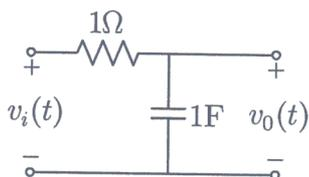
Ulazni signal u kolu prikazanom na slici je jednak  $v_i(t) = 10e^{-5t}h(t)$  V. Odrediti energiju izlaznog signala  $v_0(t)$  razvijenu na otporniku od  $1\Omega$  u frekventnom opsegu  $2 < \omega < 4$  rad/s.
