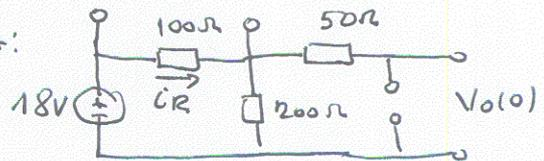
KOLO U S-DOMENU (NAKON ZATVARANJA PREKIDAČA)
